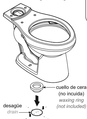
Instalación usando Cuello de Cera Installation using Wax Ring
