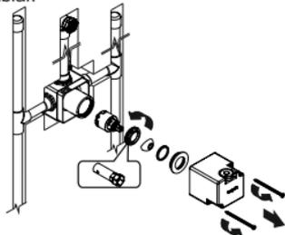
7. Mantenga hermética la instalación y genere una prueba de fuga a la presión de operación (0,8 - 6 kg/cm<sup>2</sup>).
