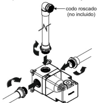
Coloque teflón en las conexiones roscadas.
