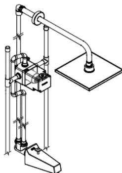
4. Enrosque los conectores (no incluidos) con tubería (no incluida) a las conexiones de la caja.
