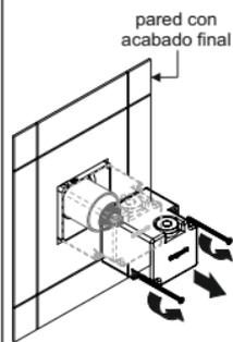
9. Recorte el sobrante de la caja. Inserte el chapetón y el maneral, posteriormente enrosque el opresor con la llave allen (incluida) para fijar.
